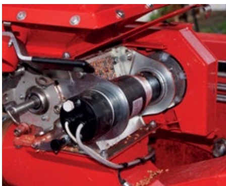
Pojedynczy system dozowania umożliwia wysiew w dawce od 0,6 do 350 kg/ha.
