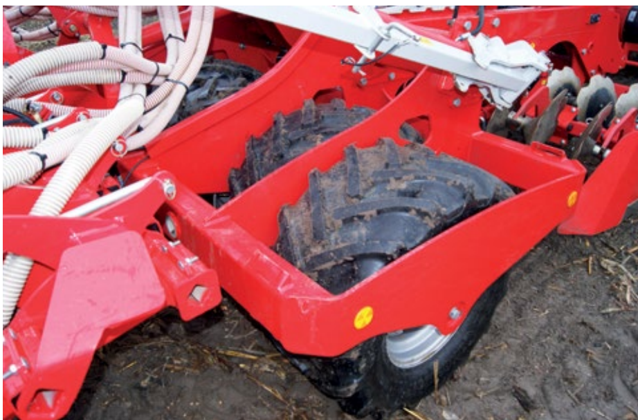
Przesunięte względem siebie koła ogumione sprawiają, że wał Packera jest lżejszy w uciążu.
