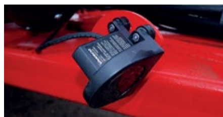
Zamontowany na maszynie radar umożliwia pomiar prędkości rzeczywistej agregatu.
