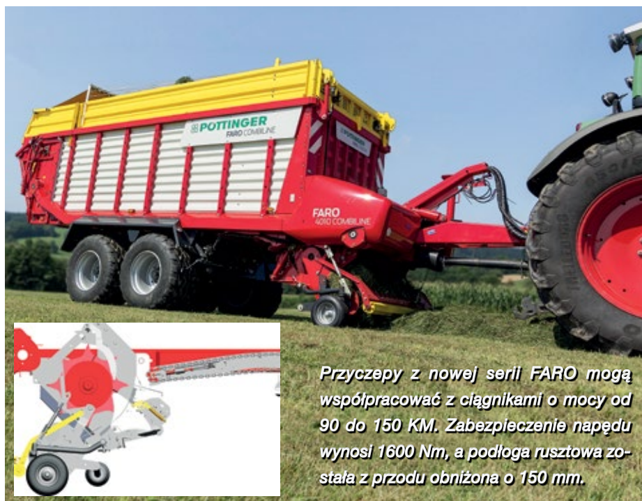
Ramową konstrukcję zabudowy w Combiline charakteryzują przechodzące mocne profile ścienne bez nabudowanych ramion. Zależnie od typu przyczepy do wyboru jest cała gama ogumienia i dwa rodzaje dyszli.
